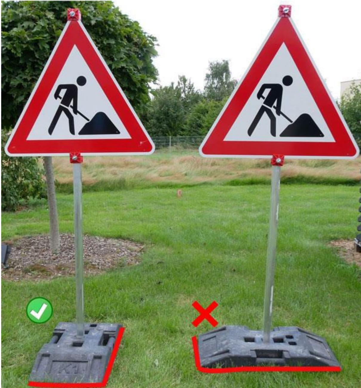
Hier sehen Sie, wie Sie die Fußplatte (bezogen auf die Windlast) unbedingt ausrichten sollten. Anderenfalls haben alle Berechnungen und Bemühungen für die korrekte Aufstellung leider keinen Sinn mehr, da der Kippmoment sich lediglich auf die Ausrichtung parallel zur Windlast bezieht.
